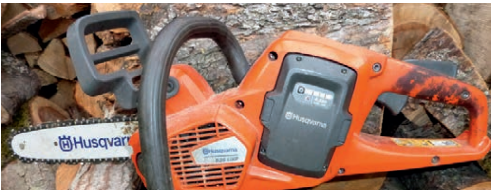
Der Einsatz einer Akku-Kettensäge reduziert Lärm und Abgase
