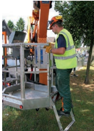
Sicheres Ein- und Aussteigen über Leiter und selbsttätig schließende Tür
