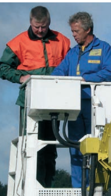
Eine zweite am Boden befindliche Person muss ebenfalls die Hubarbeitsbühne bedienen können, um im Notfall notwendige Maßnahmen einzuleiten.
